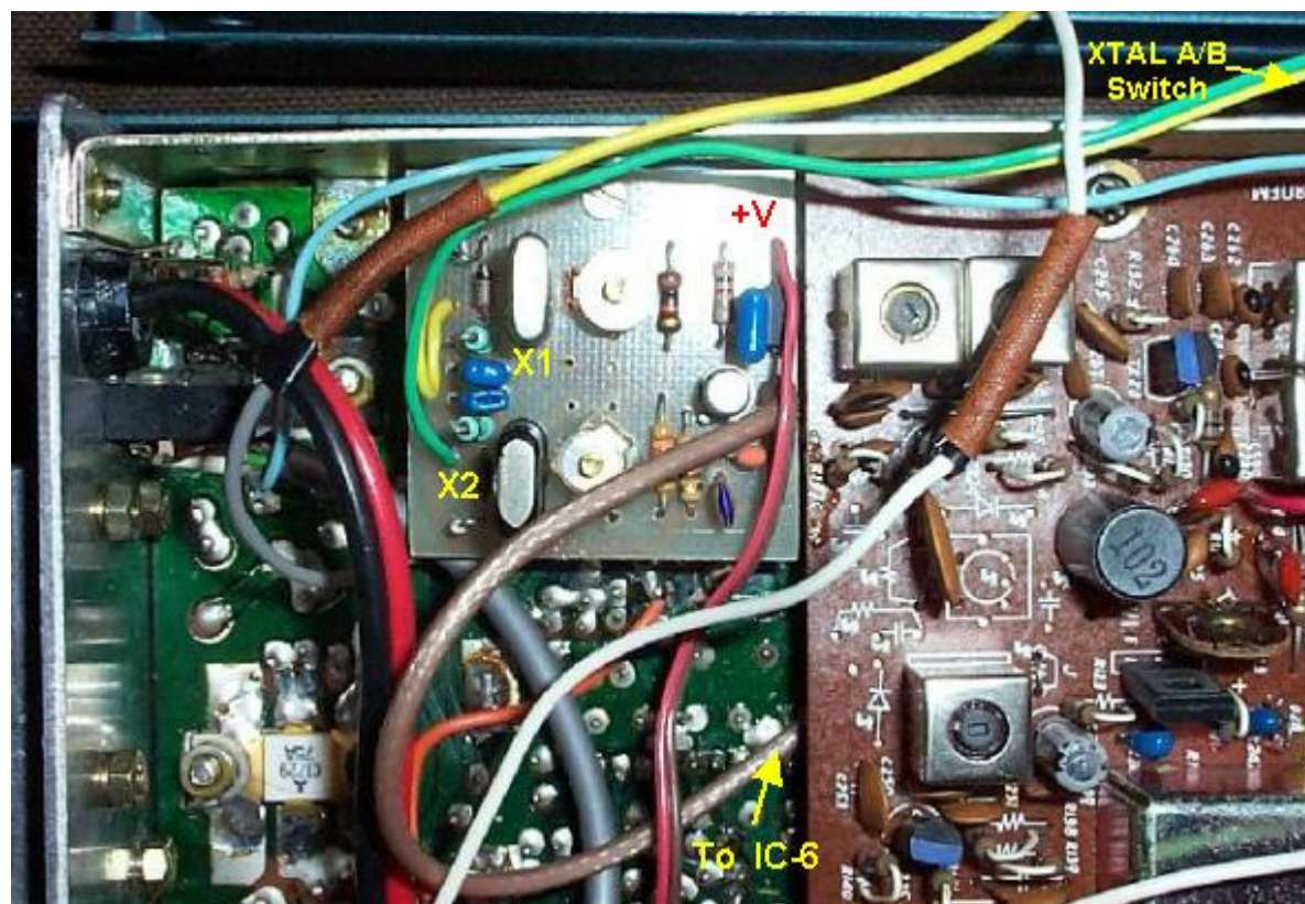
L'oscillateur externe installé du côté "module PLL".
