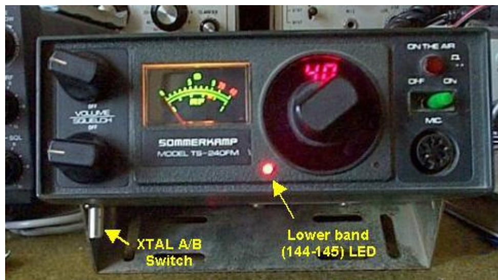
Commutateur à glissière et LED "144-145".
